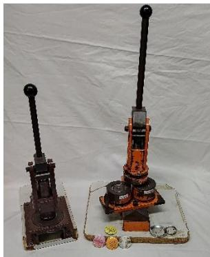
**Buttonmaschine (für große bzw. kleine Buttons)**
